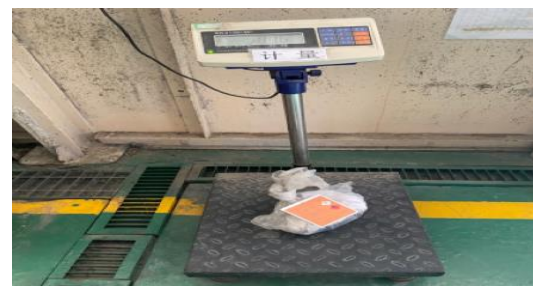
4. 使用后的抹布當危險廢棄物處置，張貼相應的危廢標籤，分類存放。
